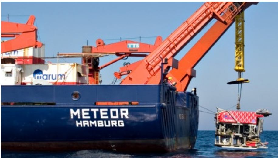
"RovQuest" wird vom Forschungsschiff Meteor in den Nordatlantik gelassen. Mit diesem Roboter können die Wissenschaftler von Marum den Meeresboden detailliert erforschen.
